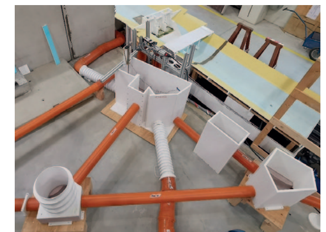
Komplexes Vereinigungsbauwerk (M 1:8) in der Übersicht
