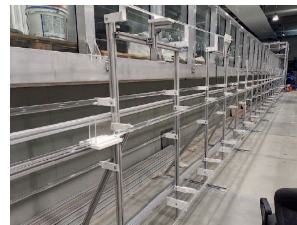
Kompletter Leitungsstrang als Linienmodell im Maßstab M 1:50
