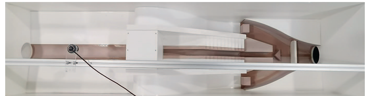
Entspannungsbauwerk (M 1:8) in der Draufsicht
